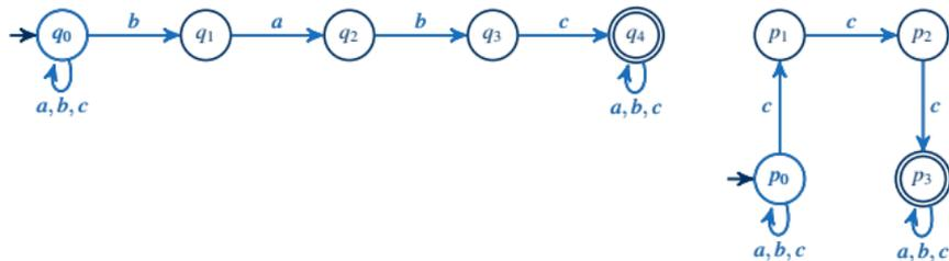
Konstruktion des Produktautomaten:
